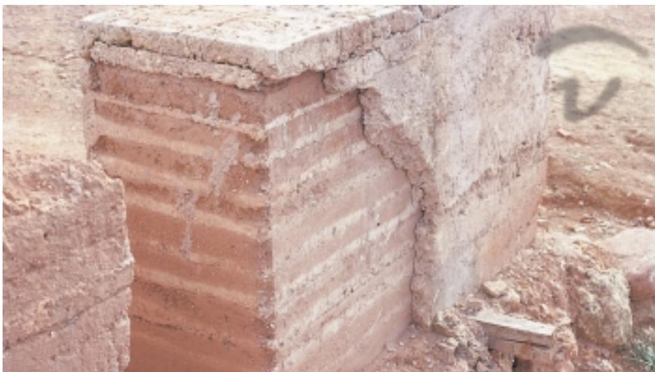
Foto 235. **Bofilla** (Laboratorio). En el tapial hay que distinguir dos partes: la costra o capa exterior y la interior. La diferencias entre ambas es notoria cuando el encofrado está compuesto fundamentalmente por tierra y la cal queda restringida a dicha costra, o se intercalaba, como se puede ver en esta muestra de laboratorio, entre las sucesivas capas de arcilla.
